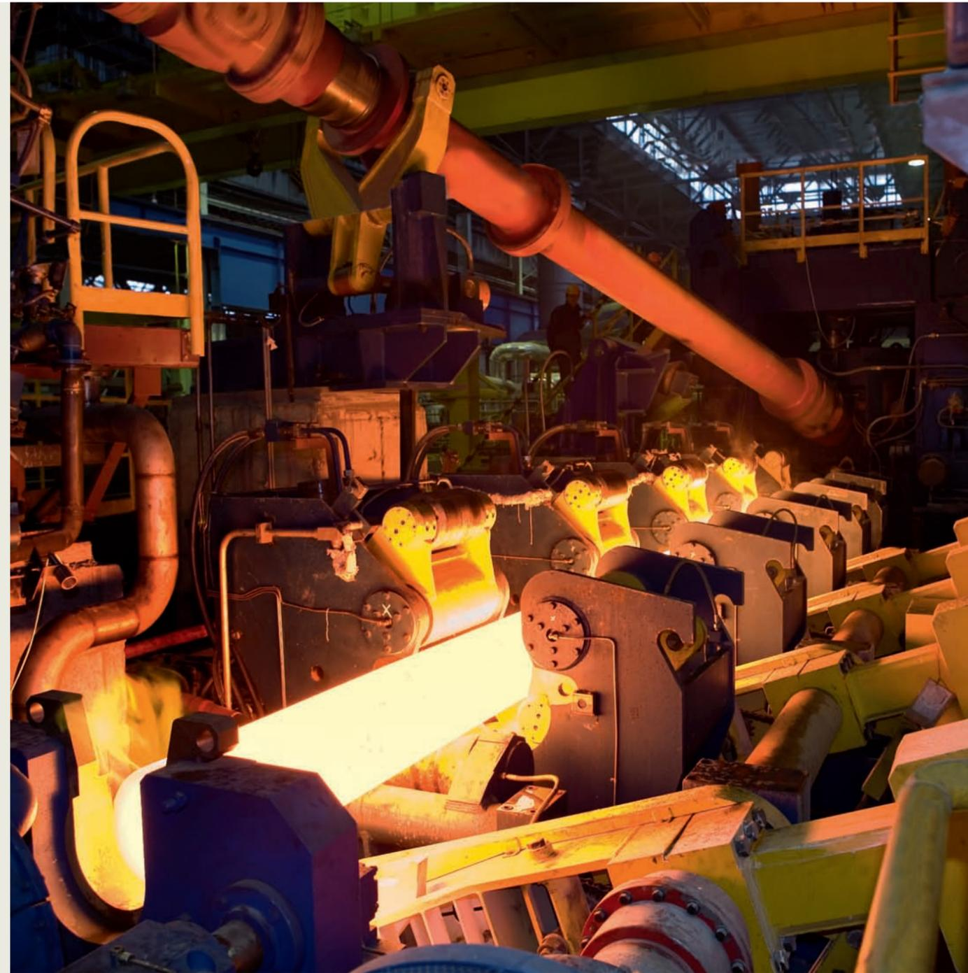
› Laminatoio per tubi senza saldature
